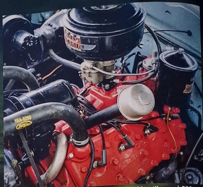
Ford var först med V8 i en folkbil och den här sidventilaren på 239 kubiktum och 110 hästkrafter är släkt i rakt nedstigande led med 32:ans V8 på 221 kubiktum och 65 hästar, en milstolpe i amerikansk bilhistoria. 1954 kom Fords nya V8 med toppventiler.
